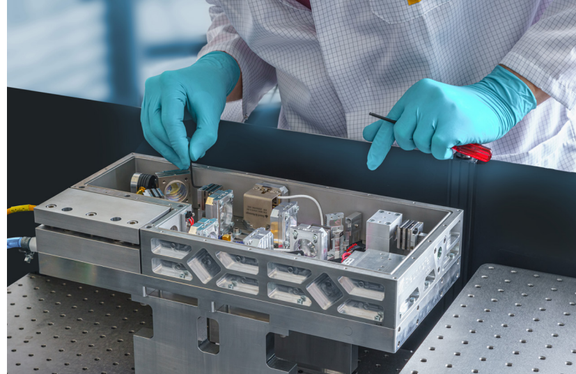
Justage eines robusten Festkörperlasers für optronische Anwendungen. © Fraunhofer IOSB.
