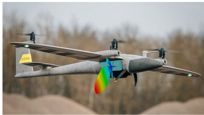
Intelligente multifunktionale Radarsensorik für autonom fliegende Systeme z.B. in Kooperation mit der Firma Quantum-Systems GmbH. © Quantum-Systems GmbH, Fraunhofer FHR
