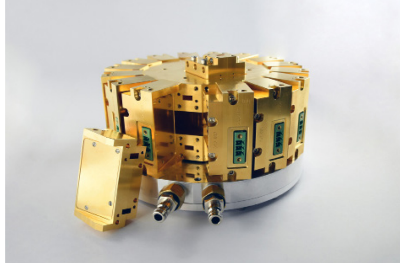
Festkörperbasierter Leistungsverstärker (SSPA).
