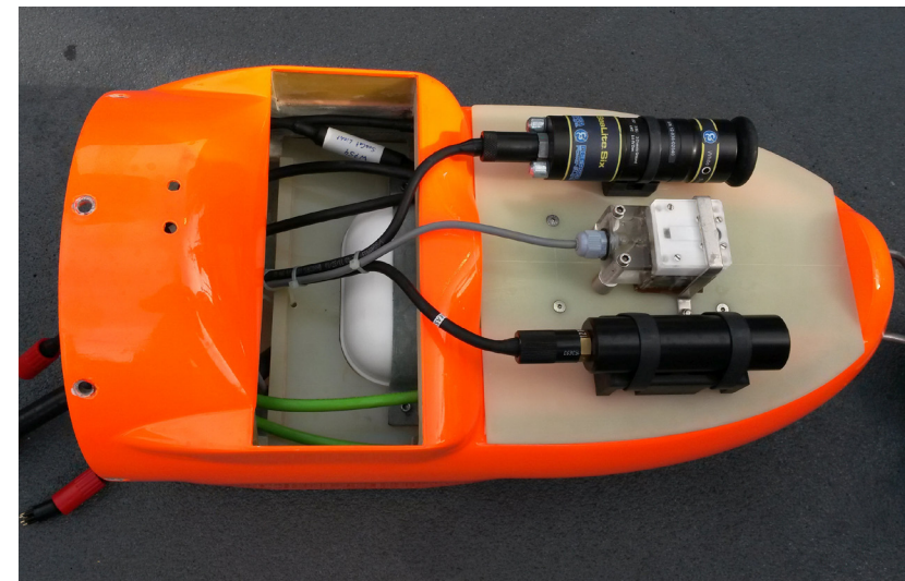
Autonomes Sensorsystem zur Detektion von Explosivstoffen im Meer
